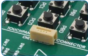
Conector de cable plano en la placa antes ...
