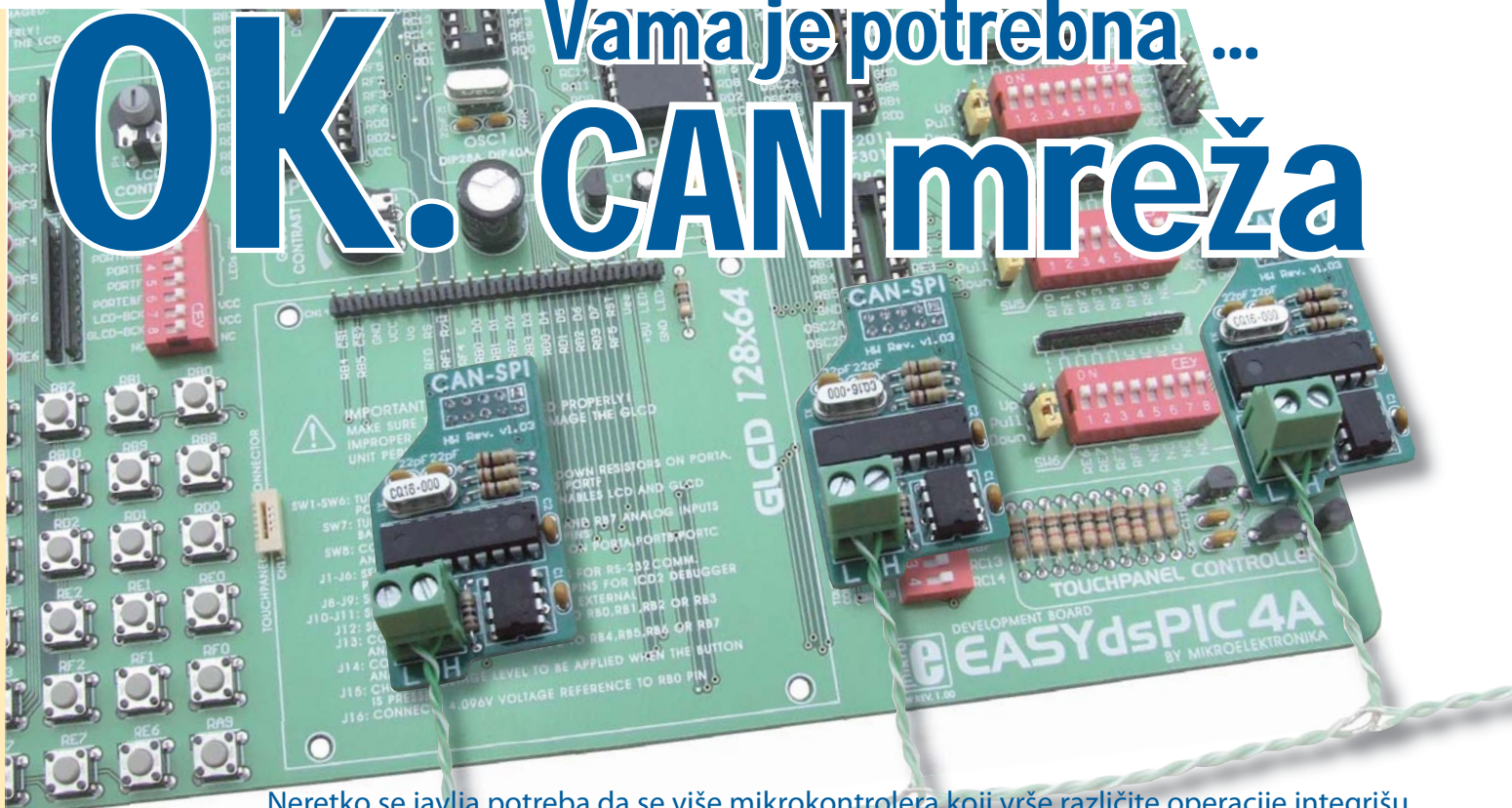
Easypic4A razvojni sistem i CAN-SPI moduli
