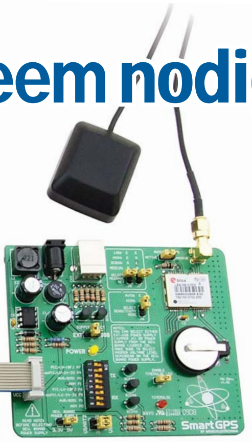
SmartGPS-module, aangesloten op het dsPICPRO4 Development System
