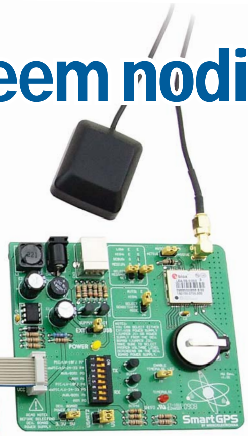
SmartGPS-module, aangesloten op het dsPICPRO4 Development System
