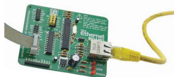
Slika 1. Pločica serijskog eterneta sa ENC28J60 čipom
