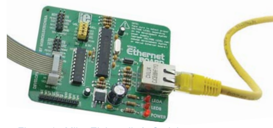
Figuur 1. MikroElektronika's Seriële Ethernet module met ENC28J60-chip
