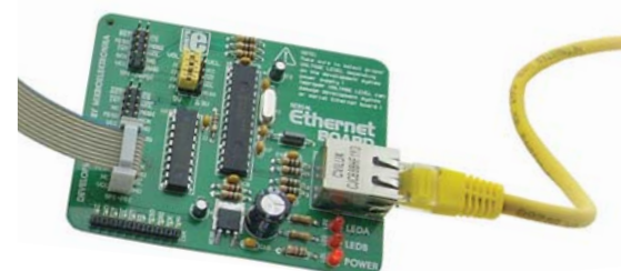
Figuur 1. MikroElektronika's Seriële Ethernet module met ENC28J60-chip
