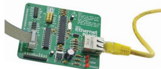
Figuur 1. MikroElektronika's Seriële Ethernet module met ENC28J60-chip
