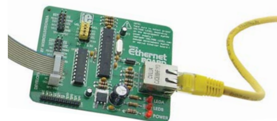
Figura 1. MikroElektronika Módulo Serie Ethernet con ENC28J60
