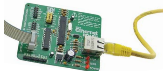
Abb. 1. MikroElektronika's Serielles Ethernet-Modul mit ENC28J60 hip
