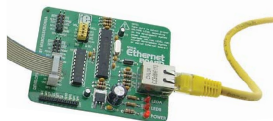
Slika 1. Pločica serijskog etneta sa ENC28J60 čipom
