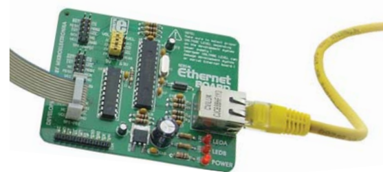
Figuur 1. MikroElektronika's Seriële Ethernet module met ENC28J60-chip
