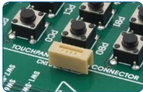
Flachkabel-Anschluss auf Platine vor ...
