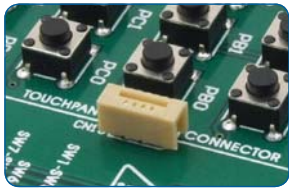
Le connecteur de nappe embarqué avant...
